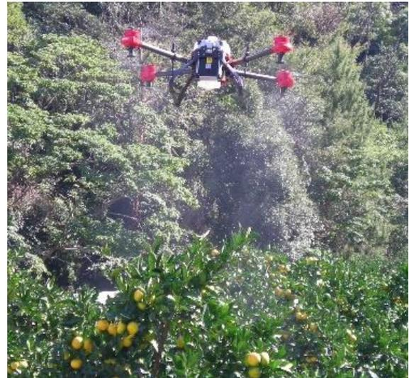
写真1 カンキツへのドローンによる農薬散布
